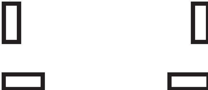
**10 Tavola di demarcazione posteriore per veicoli con una velocità massima di 30 km/h come anche per trattori con una velocità massima di 40 km/h e loro rimorchi**
