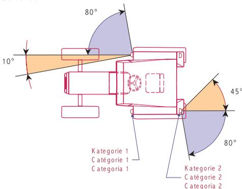
Il valore di 10° per la visibilità degli indicatori di direzione lampeggianti anteriori rivolti verso l'interno può essere ridotto a 3 per i veicoli con una larghezza non superiore ovunque a 1,40 m.
