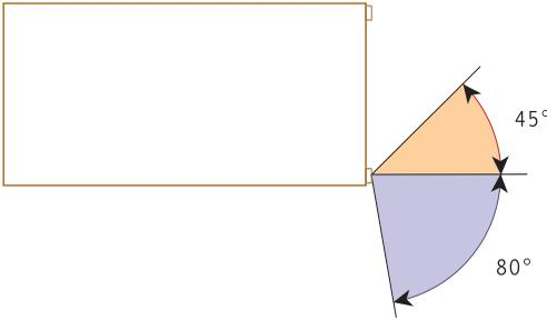
**6 Angolo di visibilità delle luci di posizione, delle luci di coda, delle luci di fermata, delle luci di ingombro e di parcheggio e dei fari fendinebbia di coda**
