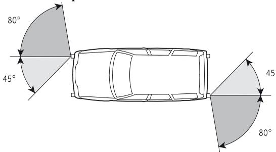
Per i veicoli delle classi  $M_1$  e  $N_1$  gli angoli di visibilità orizzontali possono essere ridotti a  $45^\circ$  verso l'esterno, se davanti risp. dietro sono montate luci di ingombro laterali supplementari con una superficie illuminante di almeno  $12,5 \text{ cm}^2$ . Per i rimorchi l'angolo di visibilità interno deve essere pari ad almeno  $5^\circ$ .
