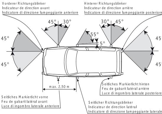
Valido soltanto per i veicoli con lunghezza fino a 6 m. Distanza tra gli indicatori di direzione lampeggianti laterali e la parte frontale del veicolo: 2,50 m al massimo. La superficie luminosa delle luci di ingombro laterali che lampeggiano insieme deve essere almeno di 12,5 cm<sup>2</sup>.
