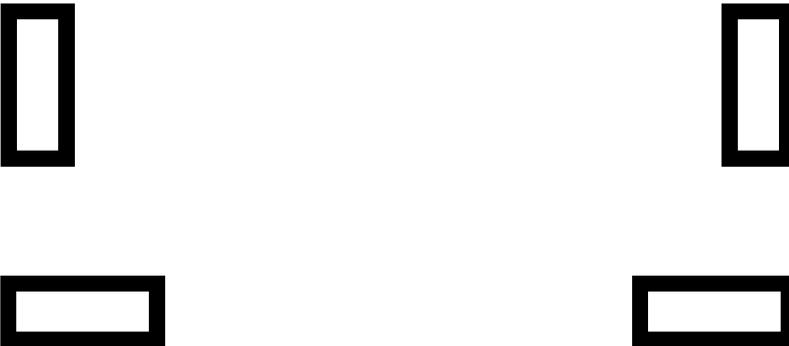
**10 Tavola di demarcazione posteriore per veicoli con una velocità massima di 30 km/h come anche per trattori con una velocità massima di 40 km/h e loro rimorchi**
