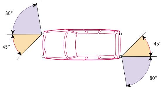
Per i veicoli delle classi  $M_1$  e  $N_1$  gli angoli di visibilità orizzontali possono essere ridotti a  $45^\circ$  verso l'esterno, se davanti risp. dietro sono montate luci di ingombro laterali supplementari con una superficie illuminante di almeno  $12,5 \text{ cm}^2$ .
