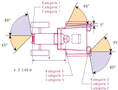
Il valore di 5° per l'angolo morto della visibilità dell'indicatore di direzione lampeggiante supplementare laterale rivolto verso il dietro è un limite superiore. Questo valore può essere aumentato a 10° se non possono essere rispettati i 5°.
