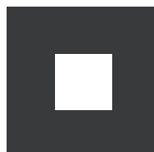
luce fissa visibile soltanto su un arco d'orizzonte limitato
