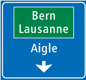
4.41 Cartello di preselezione collocato al di sopra di una corsia su strada principale (Art. 53)
