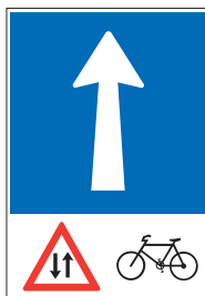
4.08.1 Senso unico con circolazione di ciclisti in senso in verso (esempio) (art. 46)
