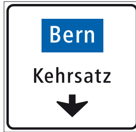
4.42 Cartello di preselezione collocato al di sopra di una corsia su strada secondaria (art. 53)
