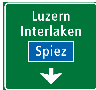
4.69 Cartello di preselezione collocato al di sopra di una corsia su autostrada o semi- autostrada (art. 86 e 87)
