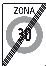
2.59.2 Fine del segnale per zone (ad es. limite di velocità massimo di 30 km/h) (art. 2a)
