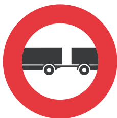
2.09.1 Divieto di circolazione per i rimorchi eccettuati i semirimorchi e i rimorchi a un asse (Art. 19)
