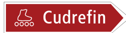
4.50.4 Indicatore di direzione «Percorso per mezzi simili a veicoli» (Esempio) (art. 54a)
