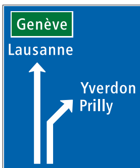
4.38 Indicatore di direzione avanzato con ripartizione delle corsie su strada principale (art. 52)
