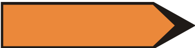
4.34.1 Indicateur de direction pour déviation sans mention du lieu de destination (art. 55)
