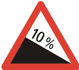
1.10 Descente dangereuse (art. 8)
