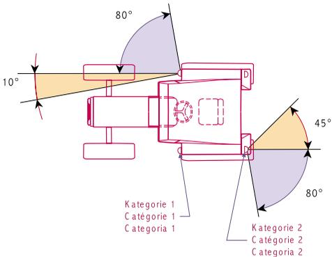
La valeur de 10° donnée pour l'angle mort de visibilité vers l'intérieur des clignoteurs de direction avant peut être ramenée à 3° pour les tracteurs dont la largeur «hors tout» ne dépasse pas 1,40 m.
