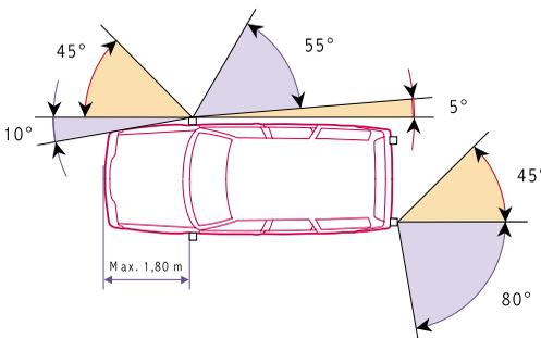
Valable seulement pour pour les véhicules qui n'appartiennent pas aux catégories M ou N. Distance entre les clignoteurs et la limite frontale du véhicule: 1,80 m au plus
