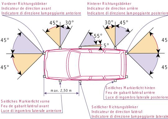
Valable seulement pour les véhicules d'une longueur maximale de 6 m. Distance entre les clignoteurs latéraux et la limite frontale du véhicule: 2,50 m au plus. La plaque éclairante des feux de gabarit latéraux clignotant simultanément doit être de 12,5 cm<sup>2</sup> au minimum pour chacun d'eux.
