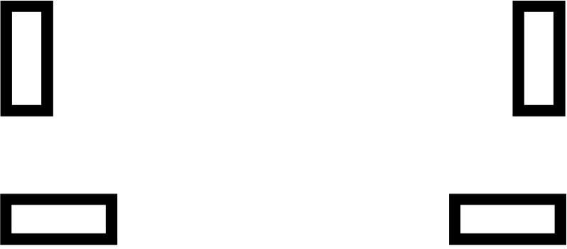
**10 Plaque d'identification arrière pour véhicules dont la vitesse maximale n'excède pas 30 km/h ainsi que pour les tracteurs dont la vitesse maximale ne dépasse pas 40 km/h et leur remorque**
