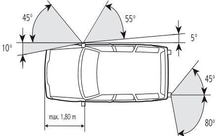
Valable seulement pour les véhicules qui n'appartiennent pas aux catégories M ou N. Distance entre les clignoteurs et la limite frontale du véhicule: 1,80 m au plus
