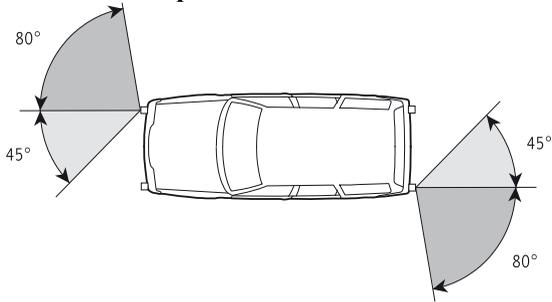
Pour les véhicules des catégories M<sub>1</sub> et N<sub>1</sub>, les angles de visibilité horizontaux peuvent être réduits à 45° vers l'extérieur, lorsque des feux de gabarit latéraux supplémentaires ayant chacun une plage éclairante d'au moins 12,5 cm<sup>2</sup> sont montés à l'avant ou à l'arrière. Pour les remorques, l'angle de visibilité vers l'intérieur doit être d'au moins 5°.
