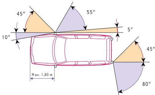
Valable seulement pour les véhicules qui n'appartiennent pas aux catégories M ou N. Distance entre les clignoteurs et la limite frontale du véhicule: 1,80 m au plus
