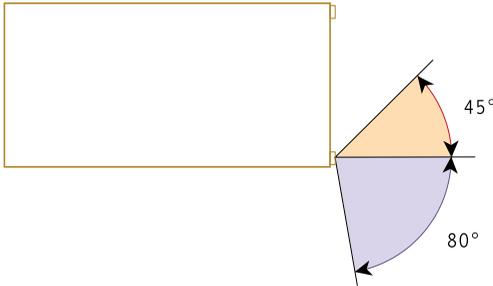
**6 Angle de visibilité des feux de position, feux arrière, feux-stop, feux de gabarit, feux de stationnement et feux arrière de brouillard**
