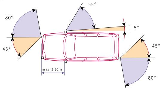
Valable pour tous les véhicules. Distance entre les clignoteurs latéraux et la limite frontale du véhicule: 2,50 m au plus
