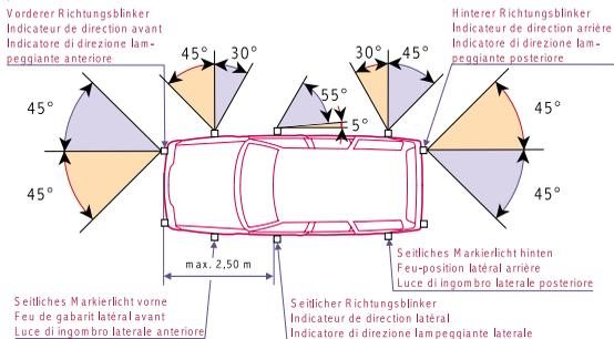
Valable seulement pour les véhicules d'une longueur maximale de 6 m. Distance entre les clignoteurs latéraux et la limite frontale du véhicule: 2,50 m au plus. La plage éclairante des feux de gabarit latéraux clignotant simultanément doit être de 12,5 cm<sup>2</sup> au minimum pour chacun d'eux.
