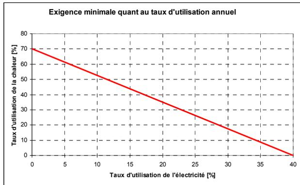
2. Le calcul du taux d'utilisation énergétique global se rapporte au pouvoir calorifique inférieur  $H_{\text{U}}$  du combustible introduit.
