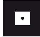
feu fixe visible sur un arc d'horizon limité, non visible pour l'observateur
