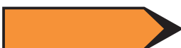
4.34.1 Indicateur de direction pour déviation sans mention du lieu de destination (art. 55)
