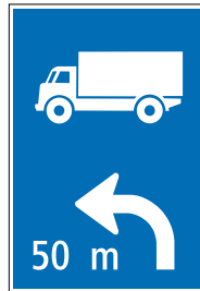
4.23 Indicateur de direction avancé pour des genres de véhicules déterminés (exemple camions) (art. 54)
