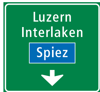
4.69 Panneau de présélection au-dessus d'une voie de circulation sur autoroute et semi-autoroute (art. 86 et 87)
