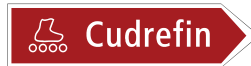
4.50.4 Indicateur de direction «Itinéraire pour engins assimilés à des véhicules» (exemple) (Art. 54a)
