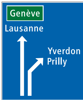
4.38 Indicateur de direction avancé avec répartition des voies sur route principale (art. 52)
