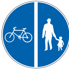
2.63 Piste cyclable et chemin pour piétons, avec partage de l'aire de circulation (exemple) (art. 33)
