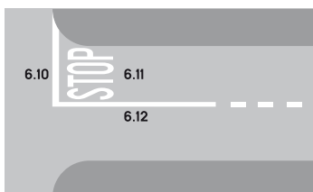
6.10 Ligne d'arrêt 6.11 Stop 6.12 Ligne longitudinale continue (art. 75)
