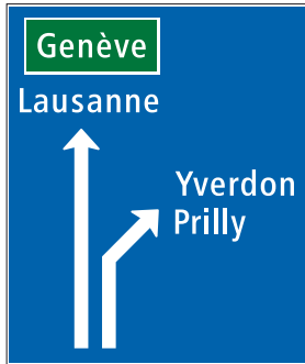
4.38 Indicateur de direction avancé avec répartition des voies sur route principale (art. 52)
