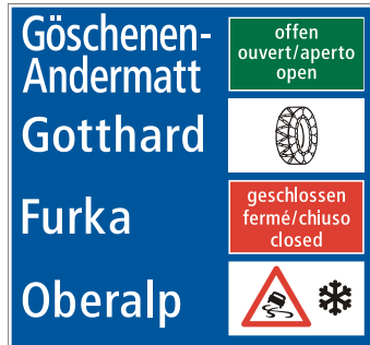
4.76 Vororientierung über den Strassenzustand (Art. 58)
