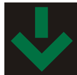
2.65 Lichtsignal-System für die zeitweilige Regulierung von Fahrstreifen
