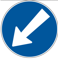
2.35 Hindernis links umfahren (Art. 24)
