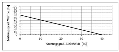
Für die Berechnung des Gesamtnutzungsgrades wird der untere Heizwert  $H_u$  des eingesetzten Brennstoffs verwendet.
