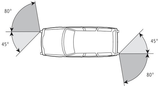
Bei Fahrzeugen der Klassen M<sub>1</sub> und N<sub>1</sub> können die horizontalen Sichtwinkel nach aussen auf 45° reduziert werden, wenn vorne bzw. hinten ergänzende seitliche Markierlichter mit einer Leuchtfäche von mindestens je 12,5 cm<sup>2</sup> angebracht sind.
