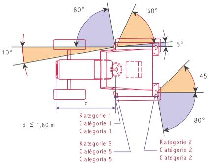
Der Wert von 5° für den toten Winkel der Sichtbarkeit des seitlichen Zusatz-Richtungsblinkers nach hinten ist eine obere Grenze. Dieser Wert kann auf 10° erhöht werden, wenn 5° nicht eingehalten werden können.
