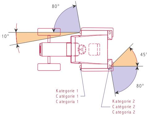
Der Wert von 10° für die Sichtbarkeit der vorderen Richtungsblinker nach innen kann bei Fahrzeugen mit einer Breite über alles von nicht mehr als 1,40 m auf 3° verringert werden.
