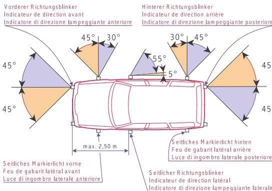
Nur für Fahrzeuge bis 6 m Länge zulässig. Distanz der seitlichen Blinker vom vorderen Fahrzeugrand höchstens 2,50 m. Die leuchtende Fläche der mitblinkenden seitlichen Markierlichter muss mindestens je 12,5 cm<sup>2</sup> betragen.
