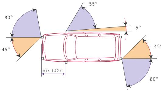
Für alle Fahrzeuge zulässig. Distanz der seitlichen Blinker vom vorderen Fahrzeugrand höchstens 2,50 m
