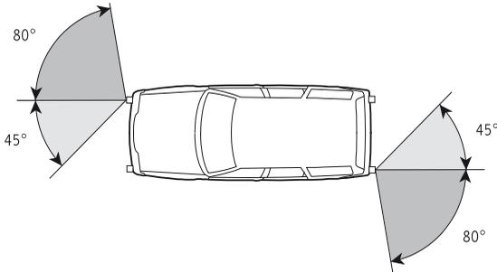
Bei Fahrzeugen der Klassen M<sub>1</sub> und N<sub>1</sub> können die horizontalen Sichtwinkel nach aussen auf 45° reduziert werden, wenn vorne bzw. hinten ergänzende seitliche Markierlichter mit einer Leuchtfläche von mindestens je 12,5 cm<sup>2</sup> angebracht sind.
