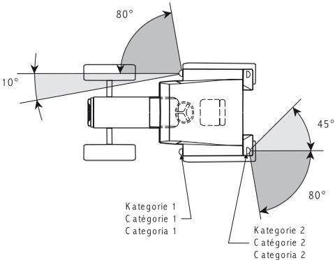
Der Wert von 10° für die Sichtbarkeit der vorderen Richtungsblinkler nach innen kann bei Fahrzeugen mit einer Breite über alles von nicht mehr als 1,40 m auf 3° verringert werden.
