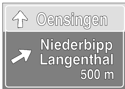
4.61 Vorwegweiser bei Anschlüssen (Art 86)
