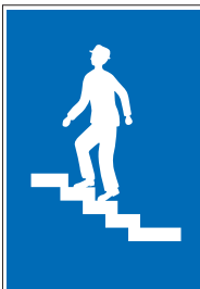
4.13 Fussgänger- Überführung (Art. 47)
