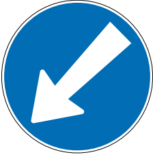
2.35 Hindernis links umfahren (Art. 24)
