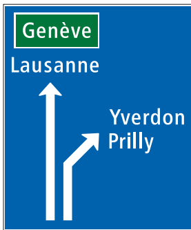
4.38 Vorwegweiser mit Fahrstreifenaufteilung auf Hauptstrassen (Art. 52)
