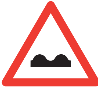
1.06 Unebene Fahrbahn (Art. 6)
