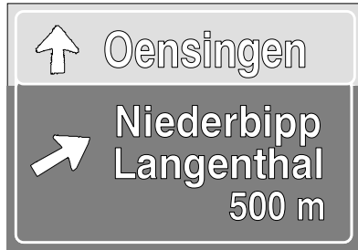
4.61 Vorwegweiser bei Anschlüssen (Art 86)
