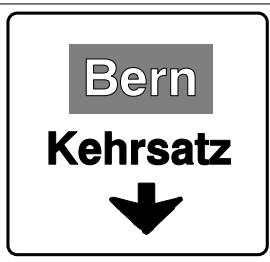
4.42 Einspurtafel über Fahrstreifen auf Nebenstrassen (Art. 53)
