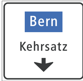
4.42 Einspurtafel über Fahrstreifen auf Nebenstrassen (Art. 53)
