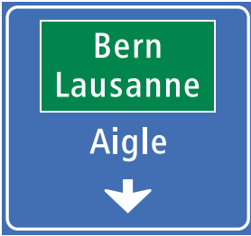
4.41 Einspurtafel über Fahrstreifen auf Hauptstrassen (Art. 53)
