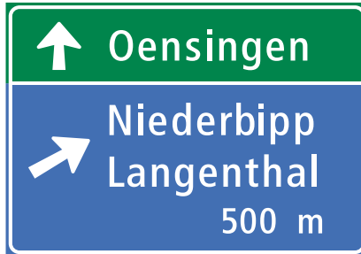
4.61 Vorwegweiser bei Anschlüssen (Art. 86)
