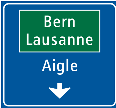
4.41 Einspurtafel über Fahrstreifen auf Hauptstrassen (Art. 53)
