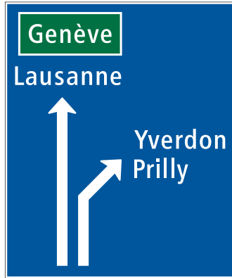
4.38 Vorwegweiser mit Fahrstreifenaufteilung auf Hauptstrassen (Art. 52)
