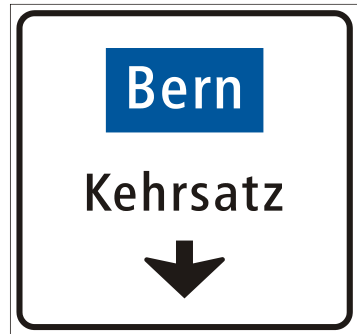
4.42 Einspurtafel über Fahrstreifen auf Nebenstrassen (Art. 53)
