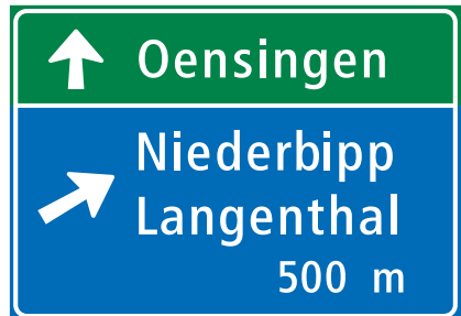
4.61 Vorwegweiser bei Anschlüssen (Art. 86)
