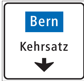
4.42 Einspurtafel über Fahrstreifen auf Nebenstrassen (Art. 53)
