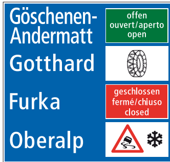
4.76 Vororientierung über den Strassenzustand (Art. 58)
