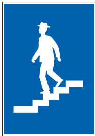
4.12 Fussgänger- Unterführung (Art. 47)
