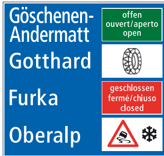
4.76 Vororientierung über den Strassenzustand (Art. 58)
