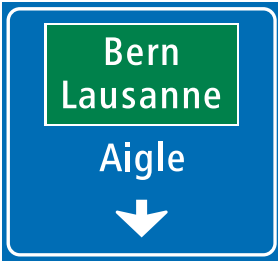
4.41 Einspurtafel über Fahrstreifen auf Hauptstrassen (Art. 53)
