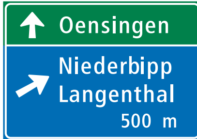
4.61 Vorwegweiser bei Anschlüssen (Art. 86)
